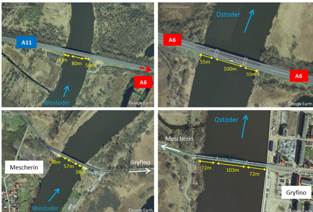
Abbildung 40: Brücken in West- und Ostoder als kritische Querschnitte für Eisversatz (google earth, Angaben der Stützweiten Gryfino - Mescherin nach Ostmann und Keil, 1939)
