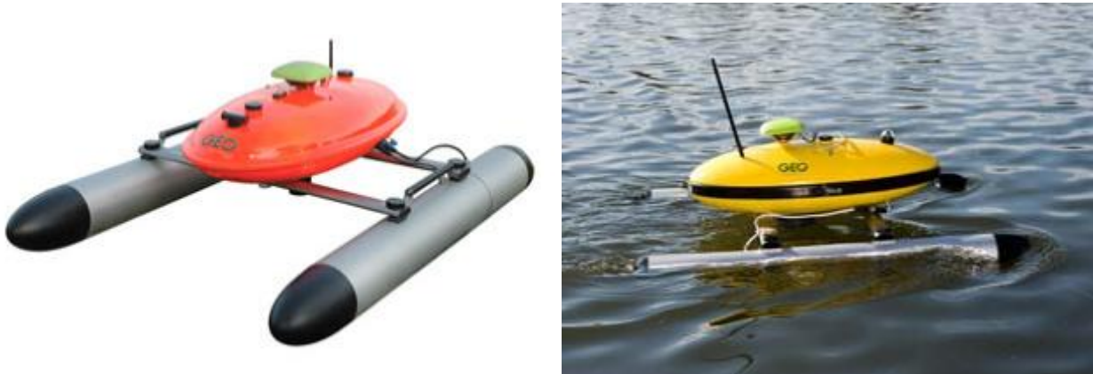
Abbildung 57: Beispiel eines autonomen GPS-Echolot-Messboots („Sonobot“ http://www.geo-dv.de )
