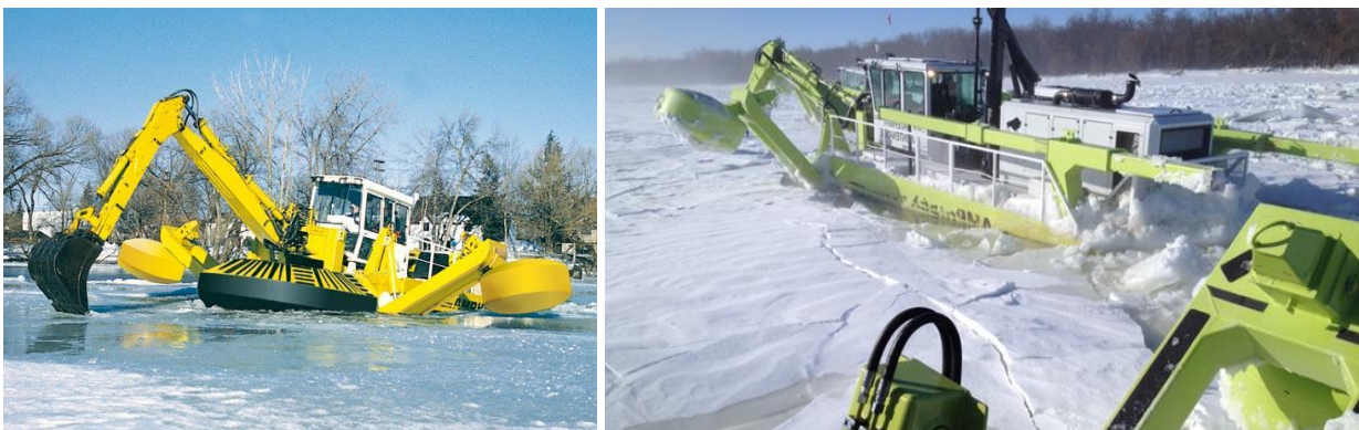
Abbildung 50: AMPHIBEX AE450E als Eisbrecher ( http://www.normrock.ca/ und https://i.cbc.ca )
